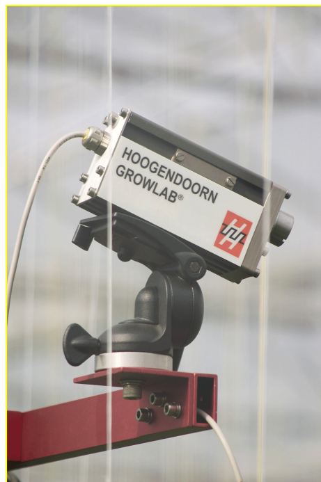
De GROWLAB Planttemperatuur camera meet de temperatuur van de plant met behulp van infrarood.
